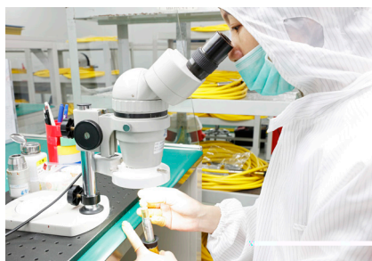
显微镜上安装光纤连接器
